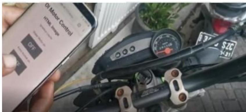
Gambar 3.4. Mematikan kunci kontak motor Pengujian fungsi sistem alat yang dilakukan untuk
