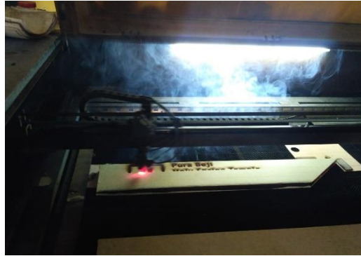
Gambar 3. Proses engraving. mengukir dengan laser [Sumber: dokumentasi penulis, 2019]
