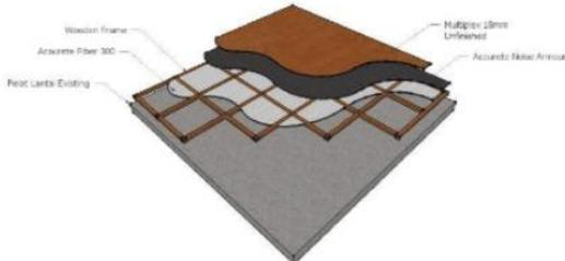
Gambar 4. Konstruksi akustik lantai
