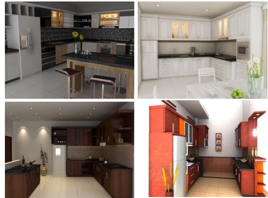
Gambar 9. Desain dapur dengan susunan perabot tidak sesuai alur kerja
